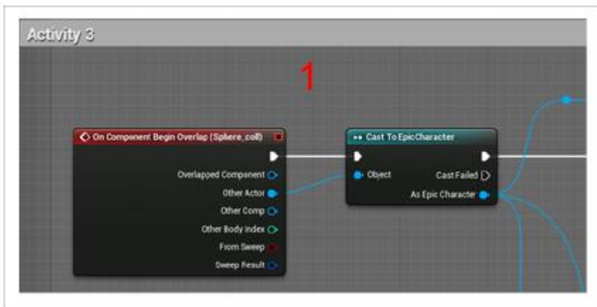
图 005a - 当玩家触碰到跳跃加成强化道具的碰撞球体后，代码就会开始运行。
